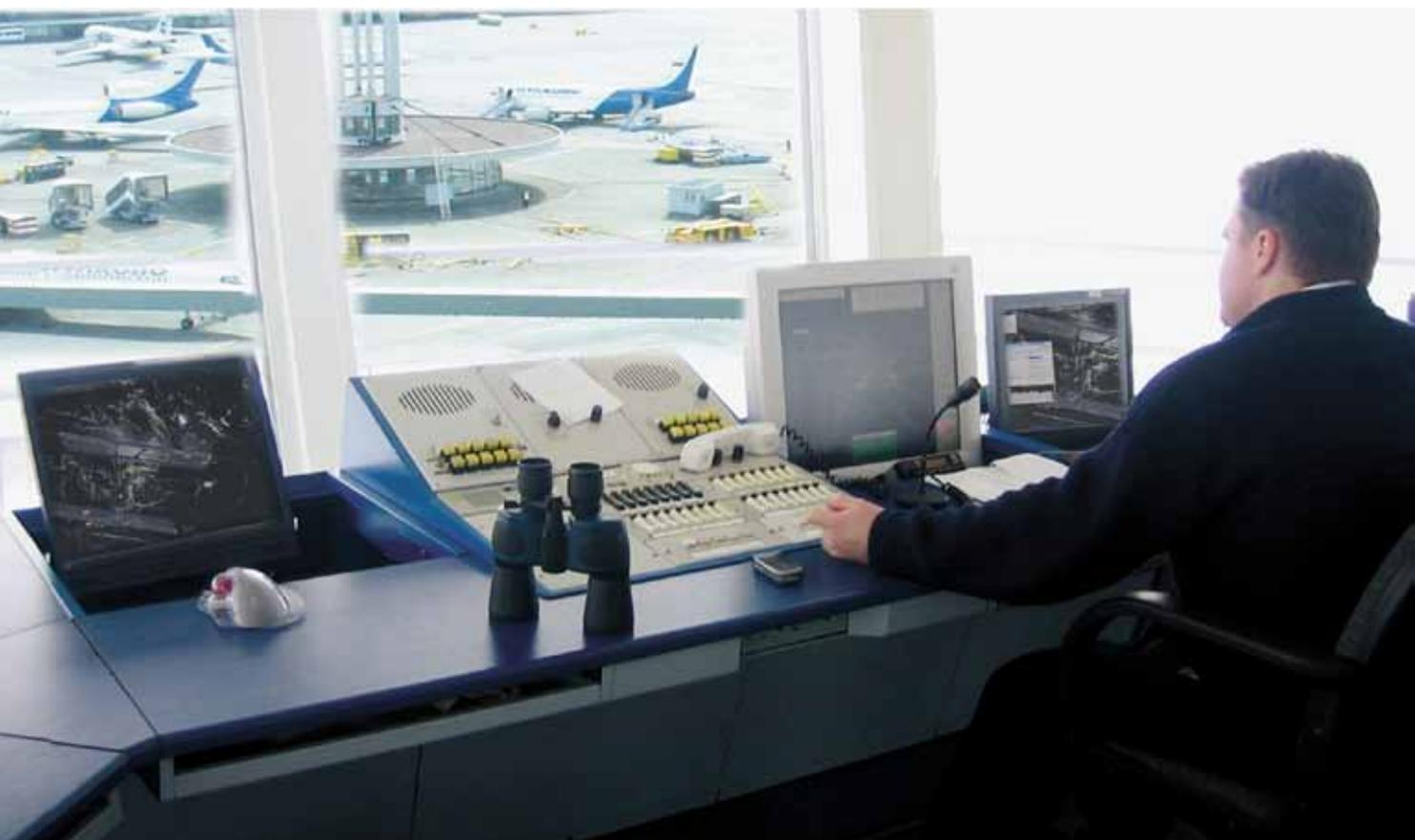
**Комплекс средств автоматизации наблюдения и контроля аэродромного движения (А-SMGCS) «Вега»**
